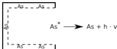
(c) Det exciterede As-atom udsender lyskvantet med en frekvens svarende til elektronspringene i As-atomet.
